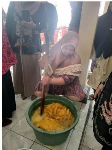
Gambar 6. Proses memasukkan kain ke dalam larutan pewarna alami
