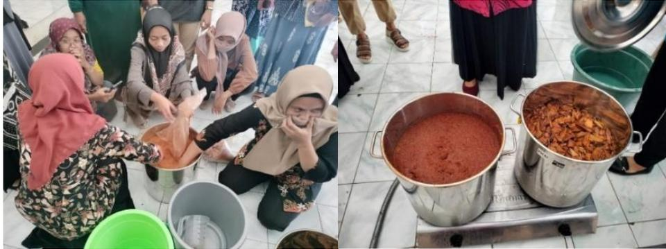
Gambar 5. Proses pencampuran pewarna alami serbuk secang dan cacahan kayu teger serta proses perebusan
