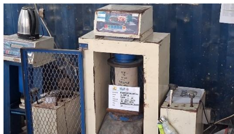
Gambar 8. Pengujian Kuat Tekan Beton
