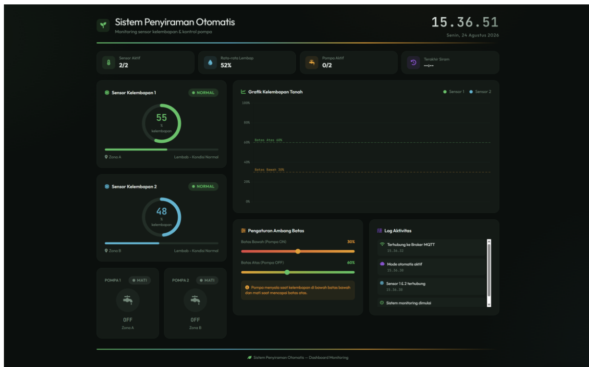
Gambar 2. Dashboard monitoring kelembapan tanah dan kontrol pompa Sumber: Dokumentasi antarmuka sistem kegiatan pengabdian.
