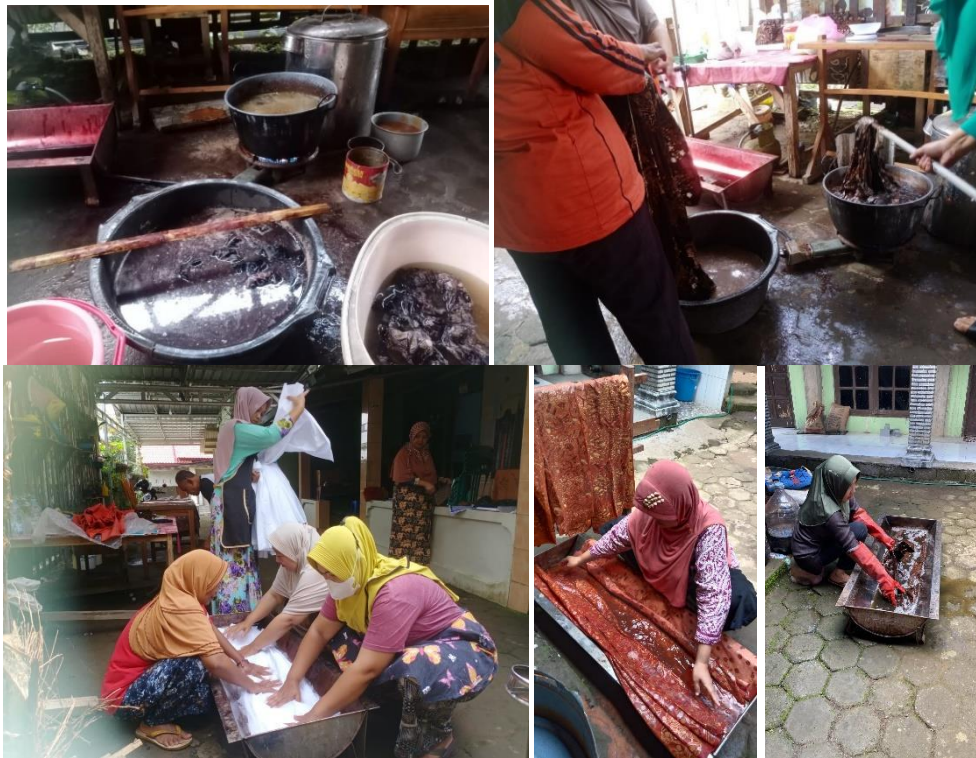
Gambar 1. Kondisi proses ekstraksi dan pencelupan konvensional untuk pewarnaan di mitra Batik Salma
