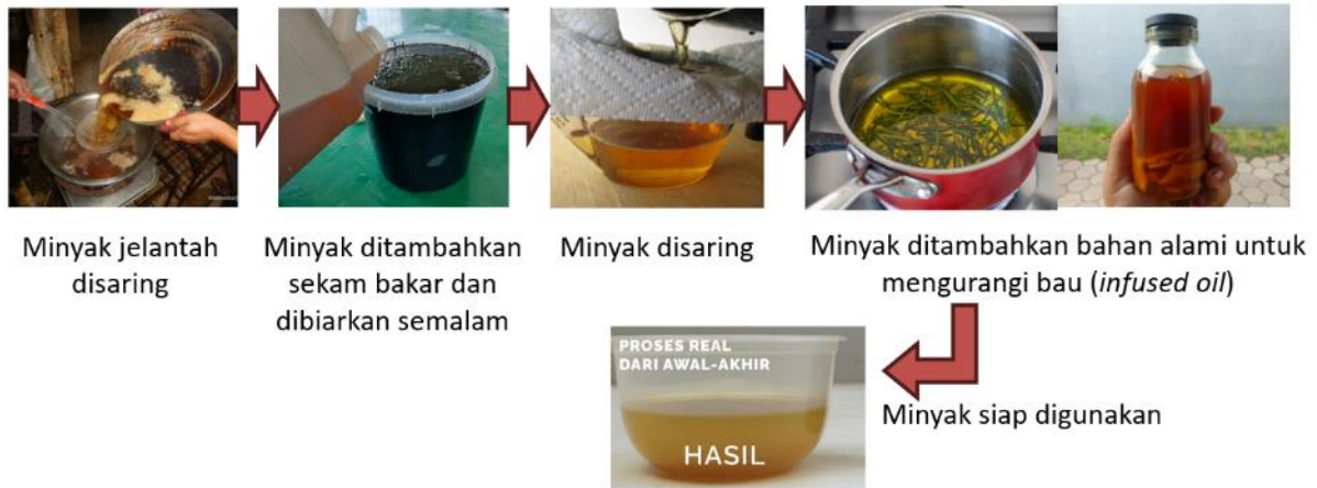
Gambar 4. Pre treatment minyak jelantah untuk pembuatan lilin aromaterapi
