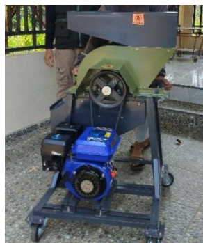
Gambar 8 Mesin pencacah sampah yang dirangkai tim PPKO SEC
